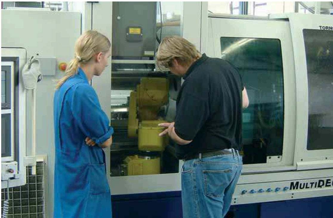
Tornos CNC-Mehrspindel-Drehautomat mit integrierter Roboterzelle der Firma Handling Tech.
