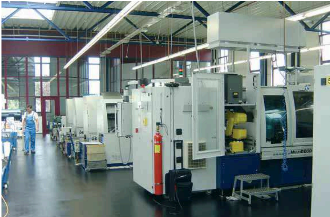
In der sauberen und großzügig gestalteten Halle stehen die Tornos CNC-Mehrschneider und CNC-Einschneider in Reihe und Glied und arbeiten zuverlässig rund um die Uhr.
